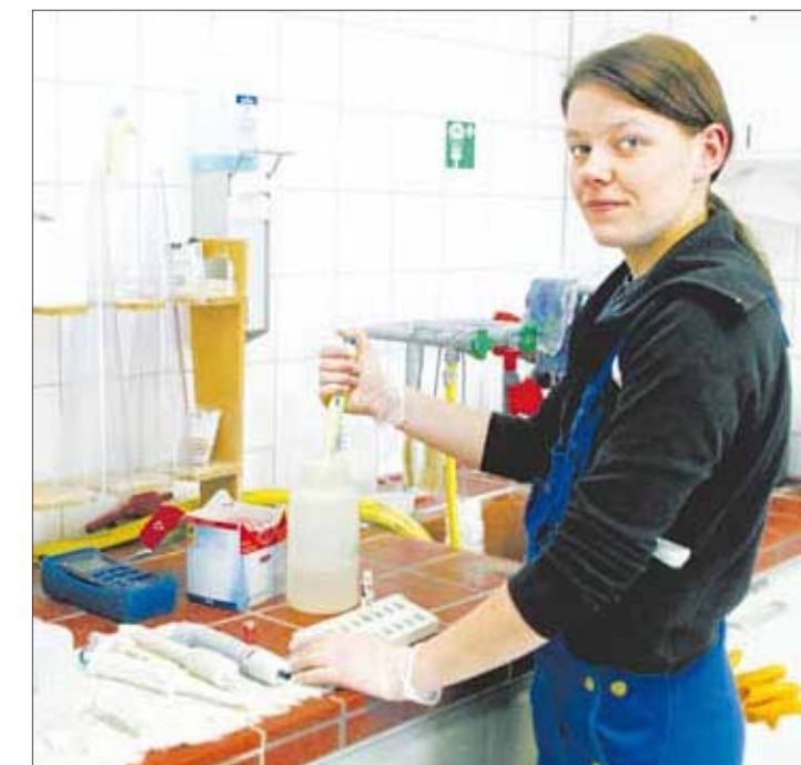
Stephanie Moegling untersucht im Küvettentest die Proben aus dem Ablauf der Kläranlage auf Stickstoffverbindungen.
